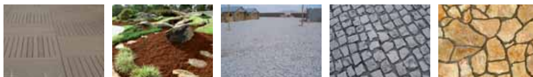
Figura 13: Altri tipi di superfici permeabili e semipermeabili.
